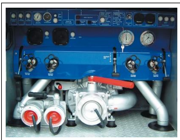
Abbildung 1: Feuerlöschkreiselpumpe als Fahrzeugeinbaupumpe
