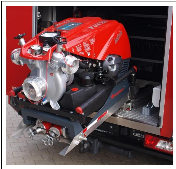
Abbildung 2: Feuerlöschkreiselpumpe als Tragkraftspritze
