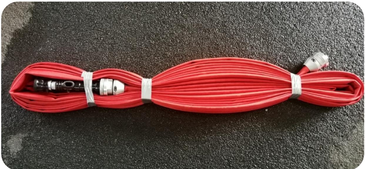
Abb. 11: Schlauchpaket im gepackten Zustand (hier mit Klebeband)
