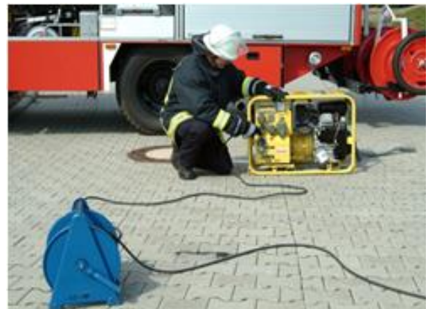
Abb. 6: Inbetriebnahme des Stromerzeugers
