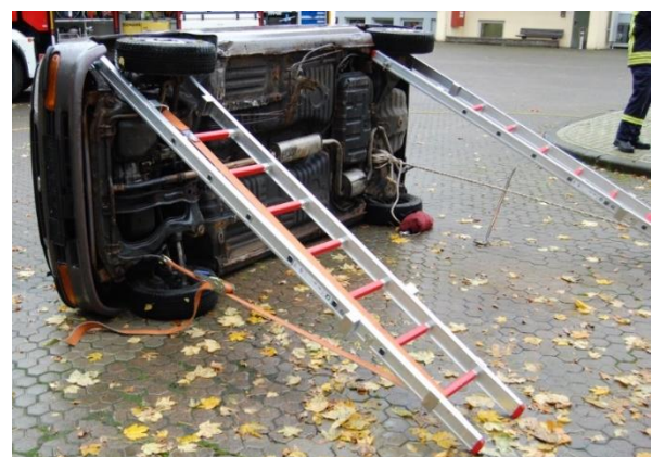
Abb. 51: Abstützen mit Steckleiterteilen
