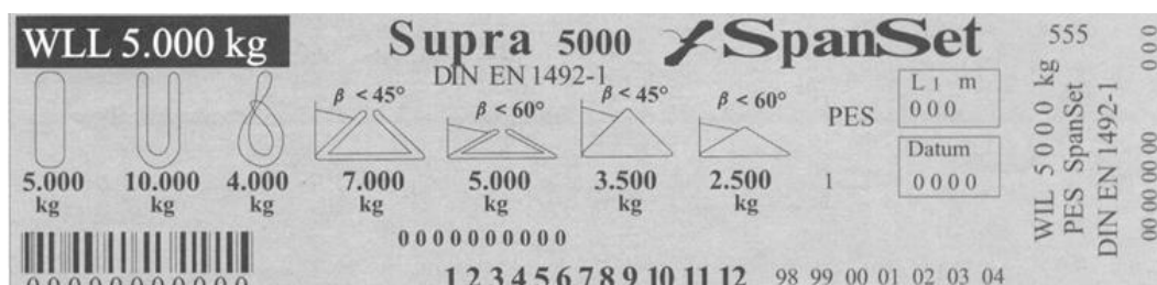
Abb. 17: Kennzeichnung von Rundschlingen und Hebebändern
