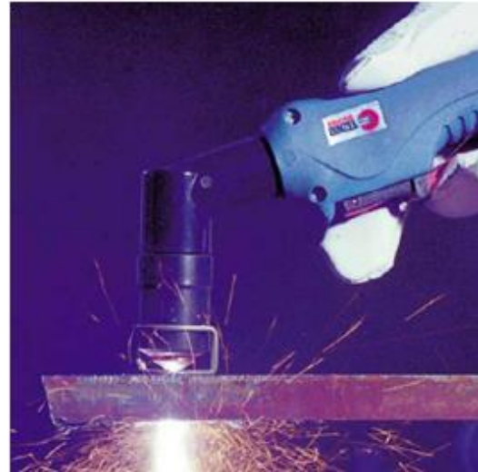
Abb. 46: Beginn auf der Werkstückoberfläche
