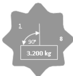
Abb. 15: Kennzeichnung einer Kette der Güteklasse 8
