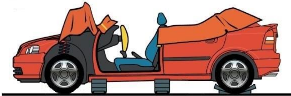
Abb. 25: Komplette Entfernung des Daches
