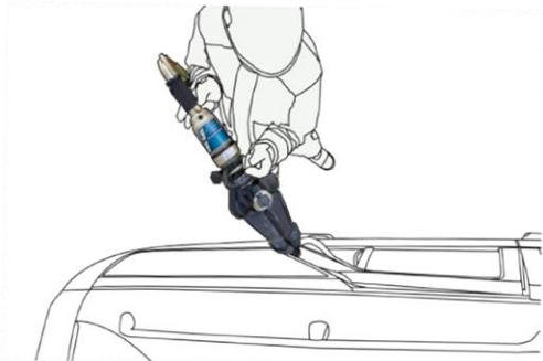
Abb. 21: Spreizer in den entstandene Spalt einsetzen
