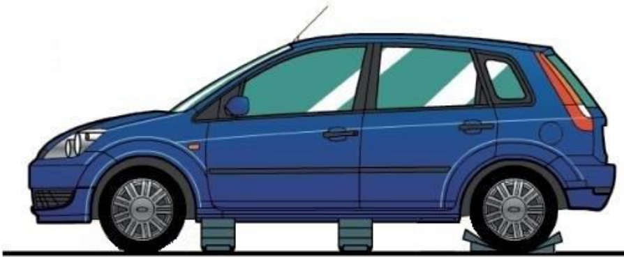
Abb. 5: Sichern und Stabilisieren eines Pkw auf Rädern
