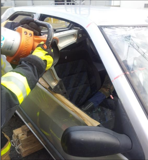
Abb. 17: Spreizer zwischen Dach und Türoberkante
