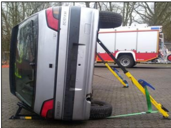
Abb. 6: Stabilisieren mit einem Abstützsystem
