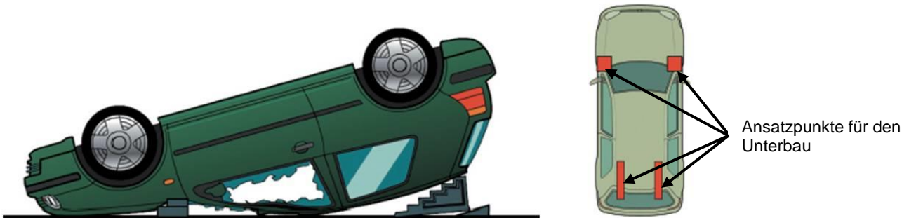
Abb. 8 Unterkeilen eines Fahrzeuges auf dem Dach
