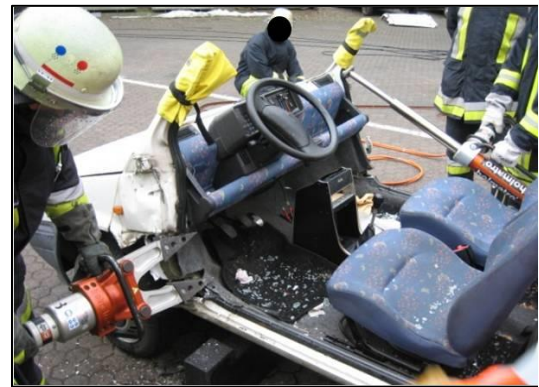
Abb. 28: Vorderwagen abklappen parallel mit Spreizer und Rettungszylinder
