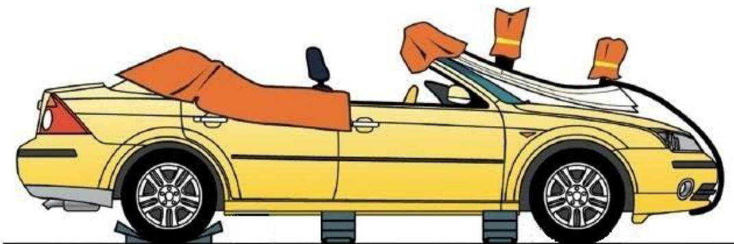
Abb. 24: Abklappen des Daches nach vorne
