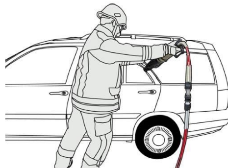
Abb. 20: Fensterrahmen um eigene Achse drehen
