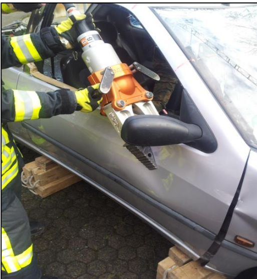
Abb. 18: Zusammendrücken der Fahrzeugtür
