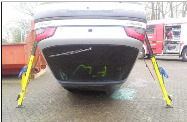
Abb. 9: Stabilisierung mit einem Abstützsystem
