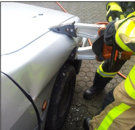
Abb. 16: Zusammendrücken des Kotflügels
