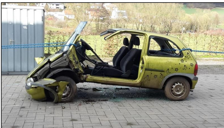
Abb. 33: Rettungsöffnung nach der „Oslo-Methode“
