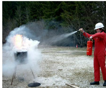
Abb. 19 und Abb. 20: Einsatz eines Fettbrandlöschers
