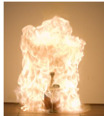
Abb. 4, Abb. 5 und Abb. 6: Verbrennung von Lycopodium (Bärklappsporen)
