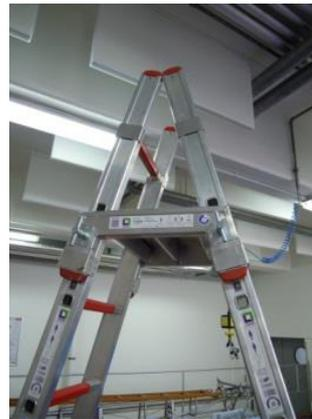
Abb. 7: Verbindungsteil mit zwei Steckleiterteilen
