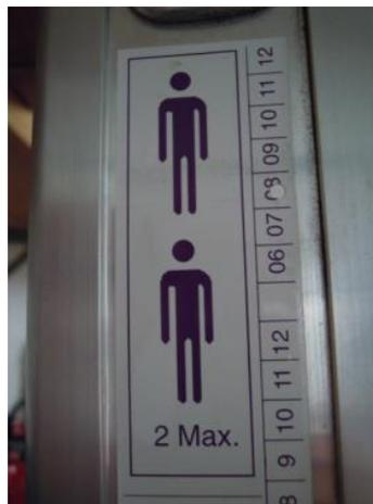
Abb. 2: Beispiel der Kennzeichnung einer Steckleiter
