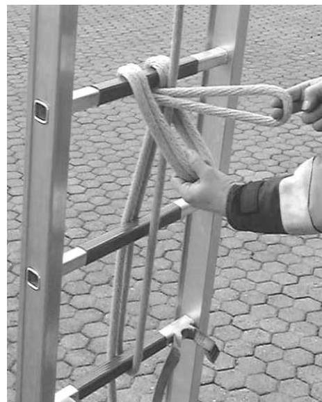
Abb. 13: Eine Schlaufe legen, das Seil um das herunterhängende Zugseil herumlegen, über der oberen Sprosse nach außen legen und unter der Sprosse hindurch durch die Schlaufe ziehen.
