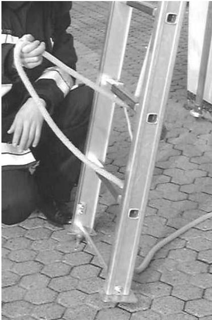
Abb. 10: Das Zugseil unter der unteren festzulegenden Spross nach außen ziehen. Nicht durch die Leiter fassen!
