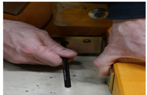
Abbildung 9: Anzeichnen Bohrloch groß
