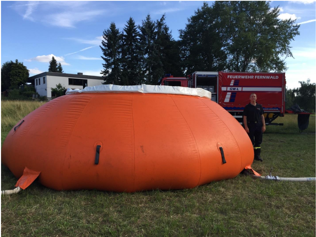
Foto 1: Löschwasserbehälter, Typ SEI Fireflex FFTF80100, Quelle: Feuerwehr Fernwald
