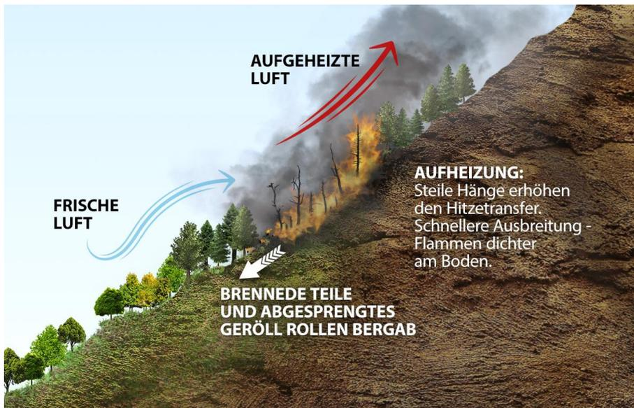
Abb. 5: Einfluss der Topografie bei einem Vegetationsbrand [1]
