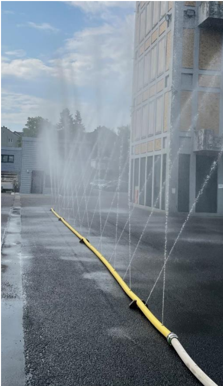
Abb. 15: Düsenschlauch im Einsatz
