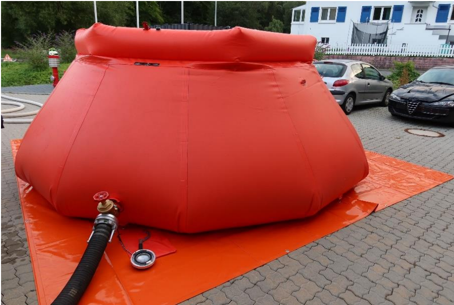
Abb. 7: Faltbehälter zur Löschwasserspeicherung, 15.000 Liter
