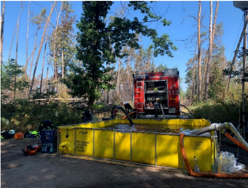
Abb. 5: Wasserübergabepunkt mit mobilem Wasserbehälter [HMDIS]
