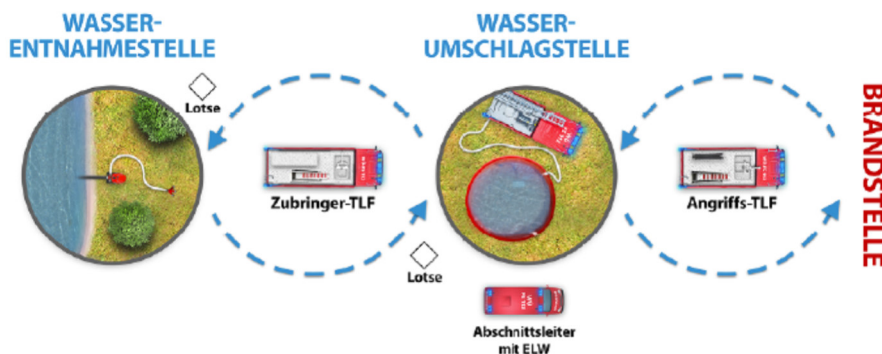
Abb. 4: Doppelter Pendelverkehr mit Tanklöschfahrzeugen [1]
