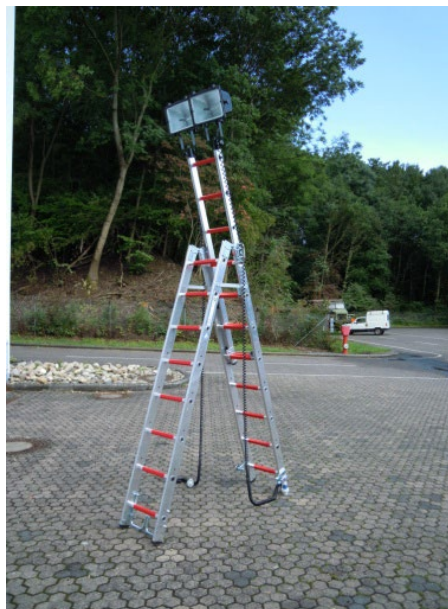
Abb. 24: Multifunktionsleiter als Behelfslichtmast
