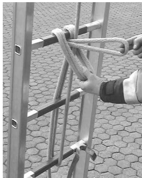
Abb. 13: Eine Schlaufe legen, das Seil um das herunterhängende Zugseil herumlegen, über der oberen Sprosse nach außen legen und unter der Sprosse hindurch durch die Schlaufe ziehen.
