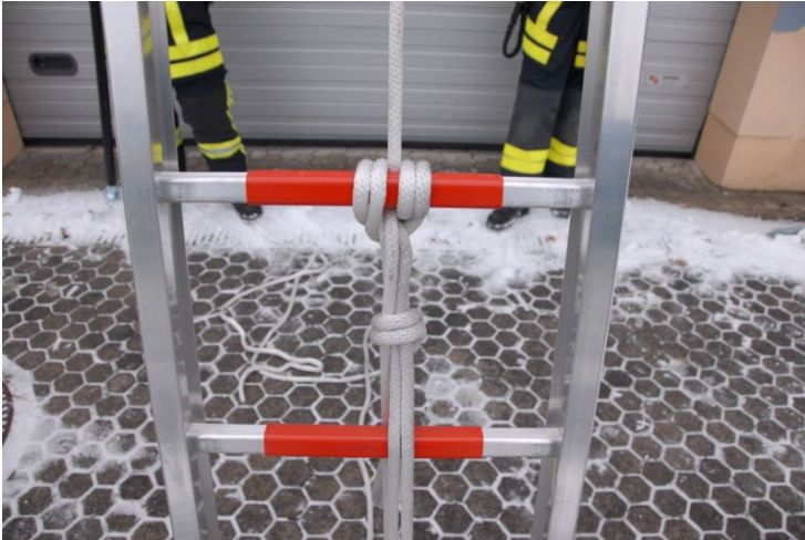
Abb. 14: Den Mastwurf mit Spierenstich sichern
