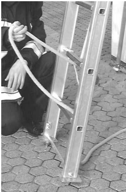
Abb. 10: Das Zugseil unter der unteren festzulegenden Sprosse nach außen ziehen. Nicht durch die Leiter fassen!
