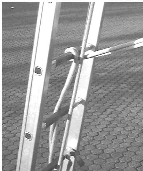
Abb. 12: Das Zugseil über die obere der drei Sprossen nach außen führen und unter der Sprosse rechts nach innen ziehen.
