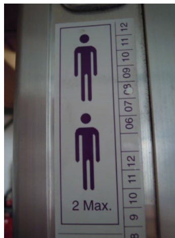
Abb. 2: Beispiel der Kennzeichnung einer Steckleiter
