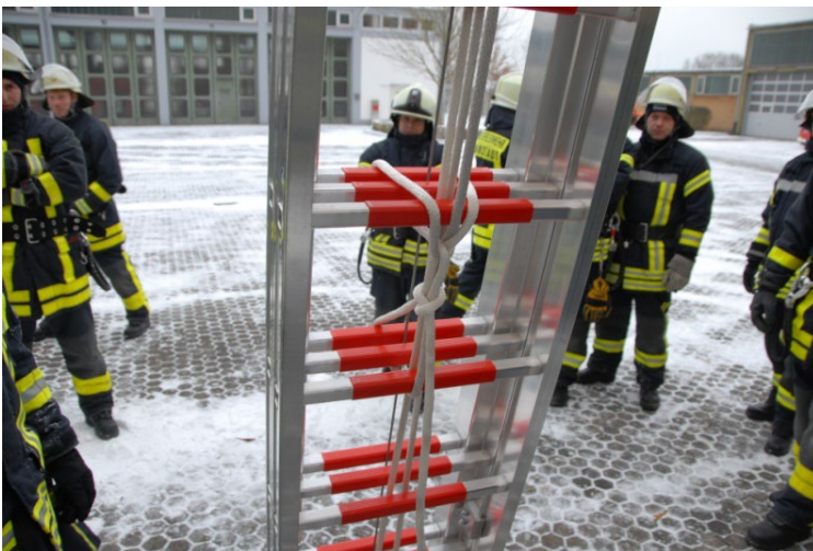
Abb. 15: Schiebleiter beim Zusammenbau gesichert mit Mastwurf und Spierenstich
