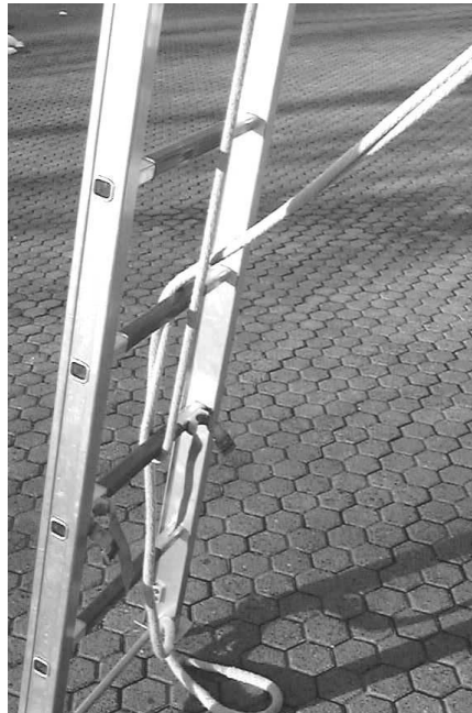
Abb. 11: Das Zugseil doppelt zwischen der mittleren und der oberen festzulegenden Sprosse nach innen ziehen.
