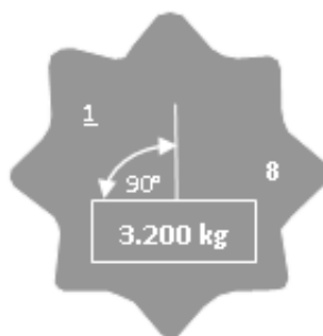
Abb. 16: Kennzeichnung einer Kette der Güteklasse 8
