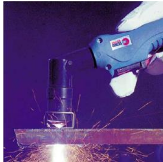
Abb. 47: Beginn auf der Werkstückoberfläche
