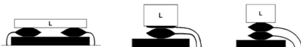
Abb. 29: Einsatzmöglichkeiten der Hebekissen
