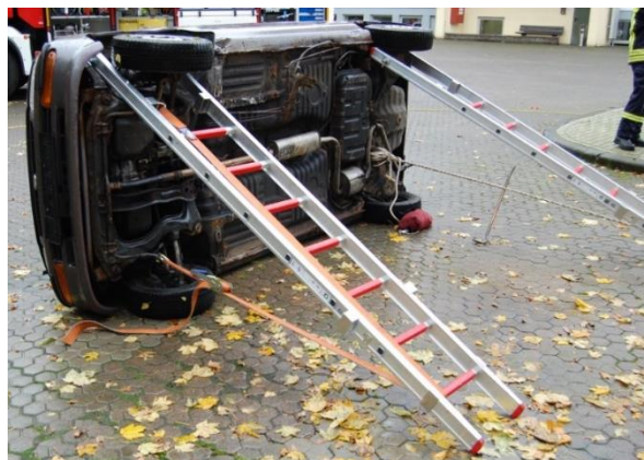
Abb. 51: Abstützen mit Steckleiterteilen
