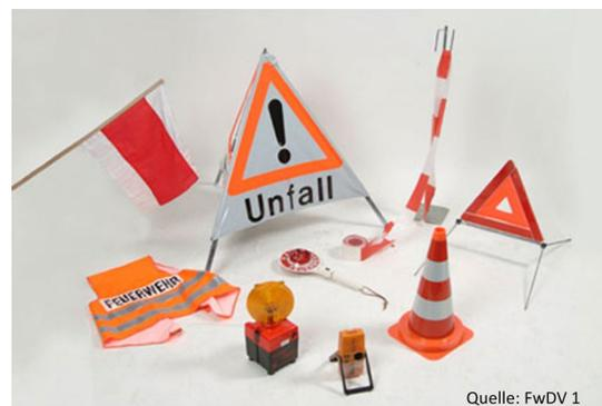
Abb. 5: Einsatzmittel zu Verkehrsabsicherung
