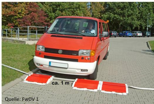
Abb. 3: Einsatz von Schlauchbrücken
