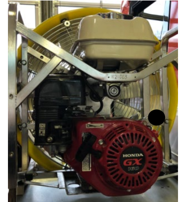
Abb. 5: Verbrennungsmotorantrieb
