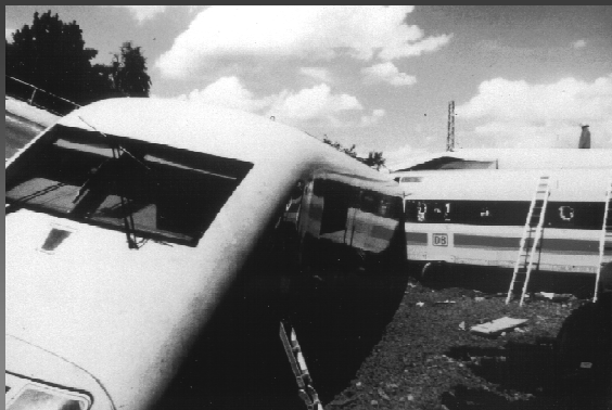
Keine Öffnung der Fenster zur Personenrettung möglich.
