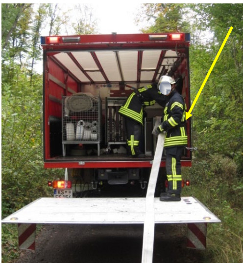
Abb. 22: Person auf der Ladebordwand mit Feuerwehrhaltegurt gesichert
