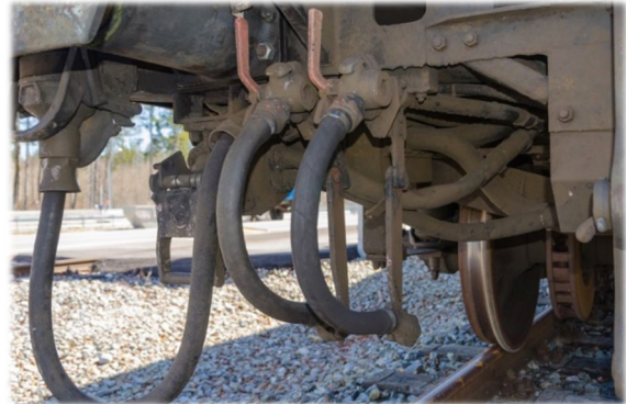
Abbildung 35: Luftleitungen mit Luftabsperrhähnen
