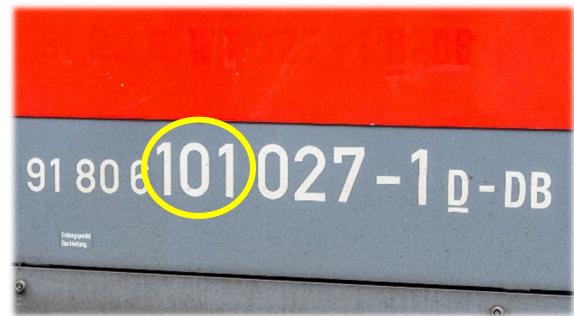
Abbildung 28: Zwölfstellige Fahrzeugnummer mit Baureihe
