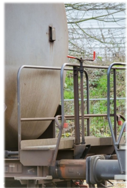
Abbildung 39: Feststellbremseinrichtungen auf der Pufferbrücke
