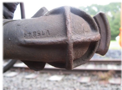
Abbildung 36: Gekennzeichneter Luftkopf einer Hauptluftbehälterleitung
