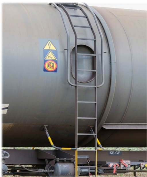
Abbildung 4: Warnhinweis Oberleitung an Fahrzeugen
