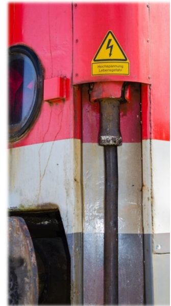
Abbildung 37: Nicht verbundene Zugsammelschiene an einem Reisezugwagen
