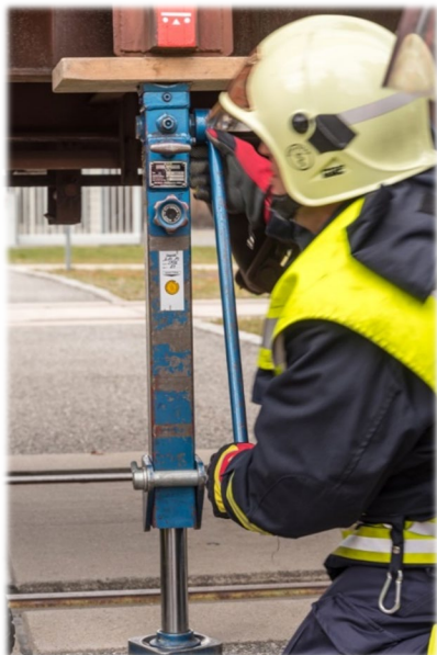
Abbildung 43: Anheben mittels Büffelheber
