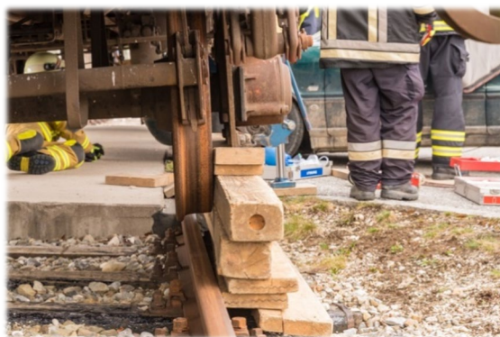
Abbildung 44: Sichern eines angehobenen Fahrzeugs durch Unterbau
