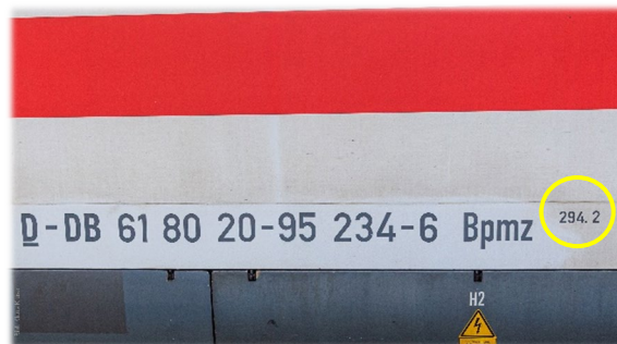
Abbildung 29: Zwölfstellige Fahrzeugnummer mit Bauartnummer
