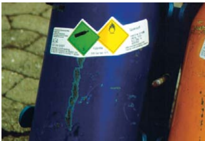
Gefahrzettel an einer Sauerstoffflasche (Transportgefäß)
