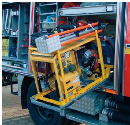
Schräglagerung des Geräteschlittens
