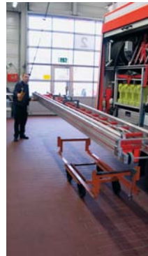
Hebezeugeinsatz und Transportwagen zum sicheren und körpergerechten Transport der Schiebleiter
