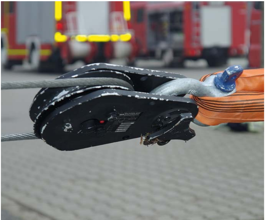
Einsatz einer losen Rolle
