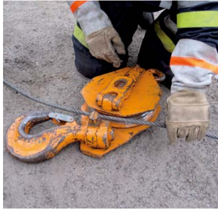
Einlegen des Drahtseiles in die Rolle
