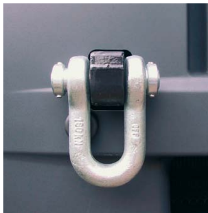
Festpunkt am Feuerwehfahrzeug (160 kN)
