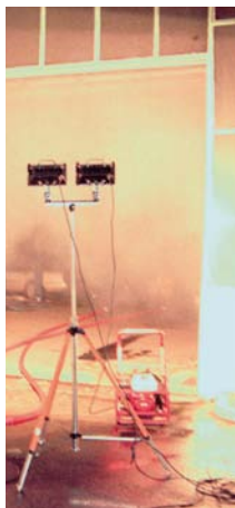
Einsatzstellenbeleuchtung durch Halogen-Flutlichtstrahler auf Teleskop-Dreibeinstativ
