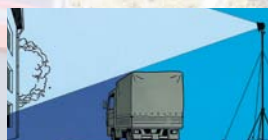
Hoch angeordnete Lichtquellen verringern die Schattenbildung.
