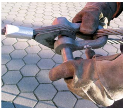
Zugseile und Anschlagseile nur mittels Schäkel verbinden.
