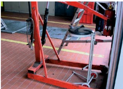
Fahrbares Hebezeug zur sicheren Aufnahme von Lasten
