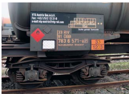
Eisenbahnwagen – Warntafel mit Kennzeichnungsnummern und Gefahrezettel
