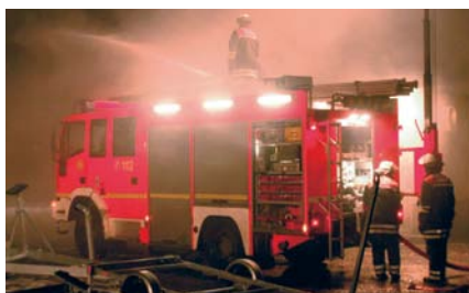
Fahrzeug-Umfeldbeleuchtung und Lichtmast am Löschfahrzeug zur Einsatzstellenbeleuchtung
