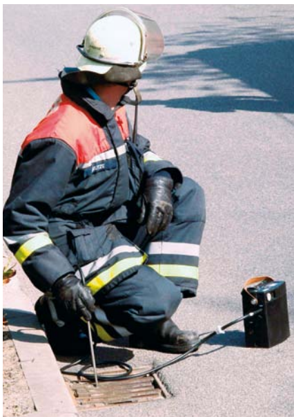
Messgeräte-Einsatz zur Feststellung von Explosionsgefahren
