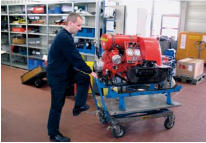
Transportwagen für Tragkraftspritzen mit mechanischer Höhenverstellung
