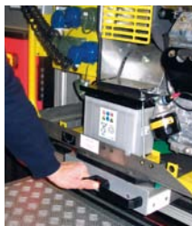
... weil beim Einschleiben des Stromerzeugers der vorhandene Handgriff nicht benutzt wird.
