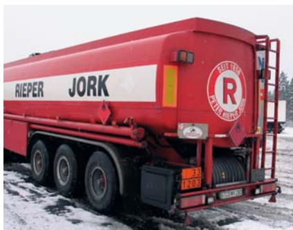
Tankfahrzeug – Warntafel mit Kennzeichnungsnummern und Gefahrezetteln
