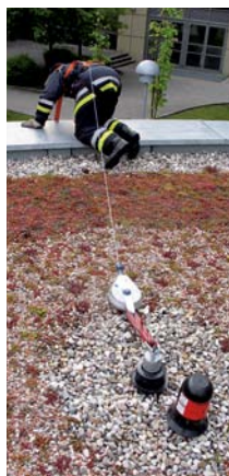
Auffanggurt mit Höhensicherungsgerät
