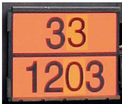
Gefahrnummer (oben) und Stoffnummer (UN-Nummer, unten)
