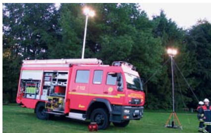
Lichtmast am Löschfahrzeug und abgespanntes Teleskop-Dreibeinstativ
