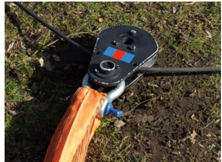
Umlenkung durch feste Rolle
