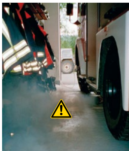
Bild 25 Dieselmotoremission bei Ausfahrt des Feuerwehrraums
