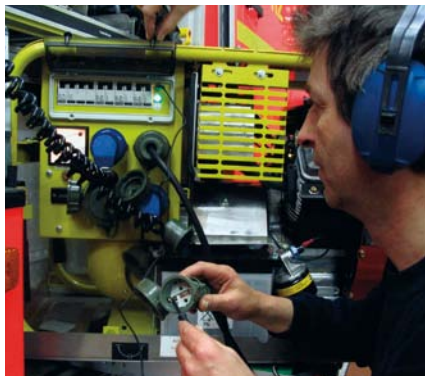
Überprüfung der Schutzmaßnahme eines tragbaren Stromerzeugers
