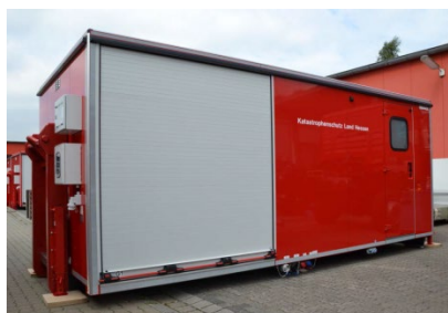
Abb. 4: Graphik: Abrollbehälter Dekontamination des Landes Hessen
