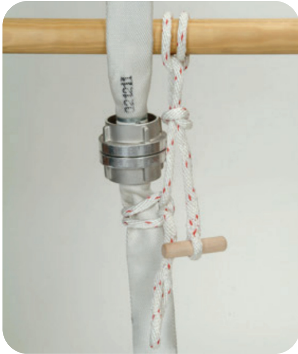
Abb. 7: Die Schlauchleitung wird an geeigneter Stelle gegen das Herunterrutschen gesichert.
