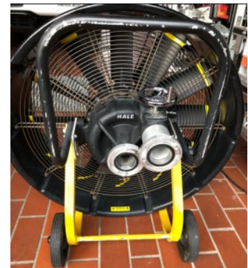
Abb. 7: Wasserstrahlantrieb
