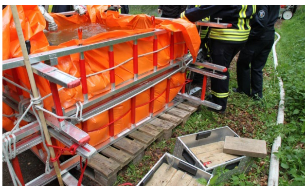
Abb. 15: Fertiger Behälter mit 8 Steckleiterteilen und Plane
