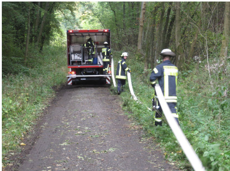
Abb. 23: Verlegen einer B-Schlauchleitung am Rand des Weges
