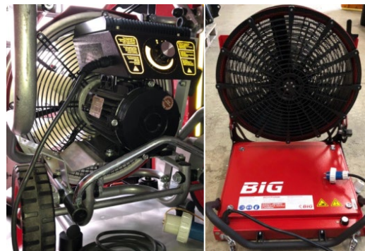
Abb. 6: Elektromotorantrieb
