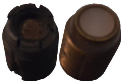
Abbildung 17 Defekter Ventilsitz (Druckbehälter)
