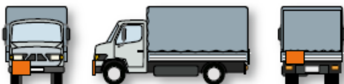
Abb. 13: Beförderung von Gefahrgut in Versandstücken (Stückguttransport) Quelle: (Feuerwehr Koordination Schweiz FKS, 2019, S. 2.043)
