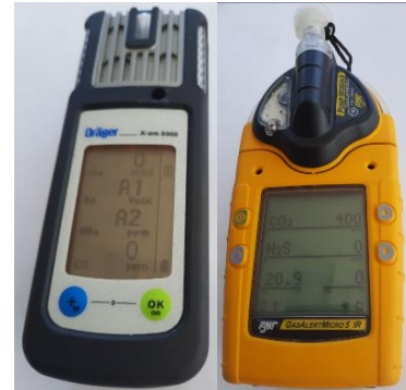
Abb. 1: Geräte zum Nachweis explosionsfähiger Gas/Dampf-Luftgemische (Dräger X-am 5000 und Gas Alert Micro 5)
