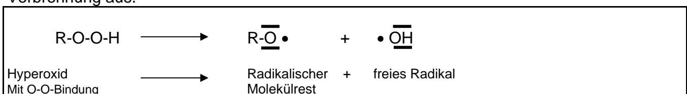
Abb. 2: Kettenreaktion der Verbrennung
