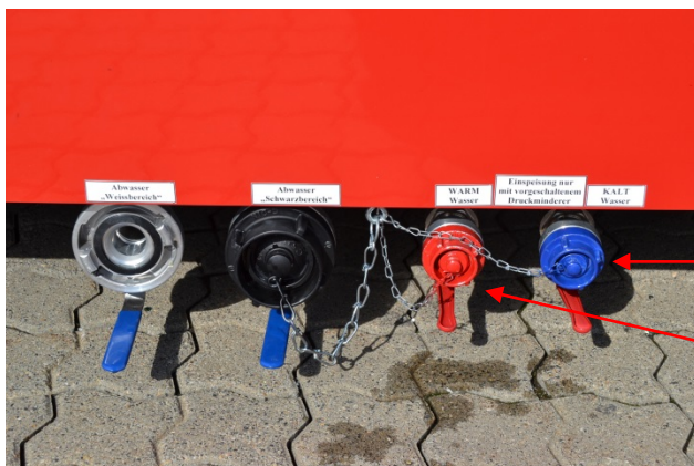
Abb.: Frishwasseranschluss linke Seite.
