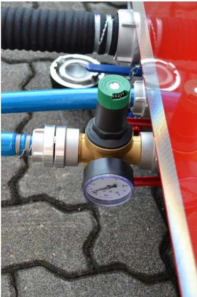
vorgeschalteter Druckminderer
