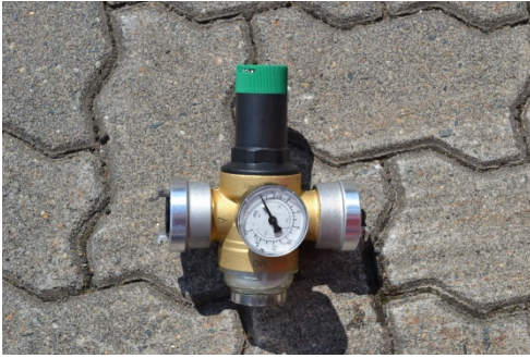
vorgeschalteter Druckminderer
