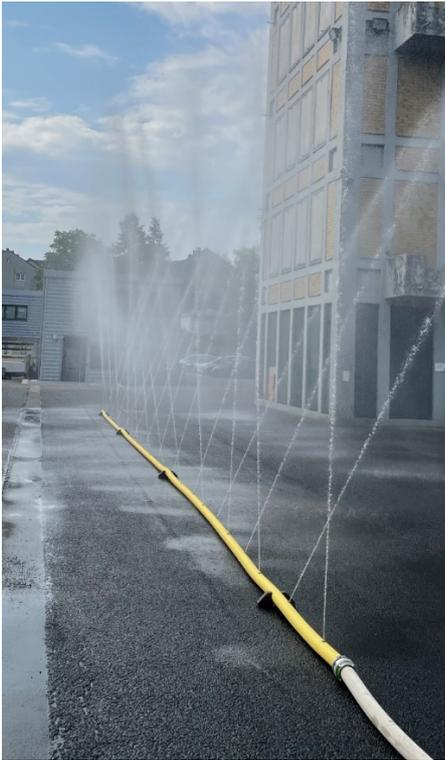
Abb. 17: Düsenschlauch im Einsatz
