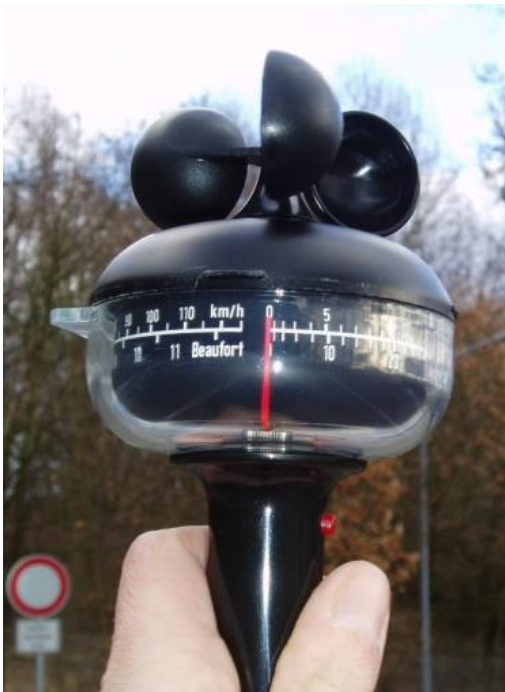
Abb. 6: Schalenanemometer
