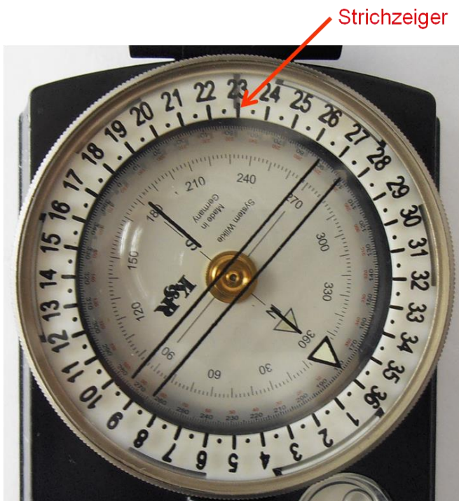
Abb. 5: Gradzahl am Strichzeiger ablesen, hier z. B. 230° Quelle: eigene Darstellung
