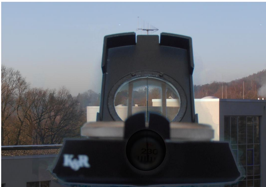
Abb. 3: Anvisieren eines markanten Objektes (hier z. B. Antennenmast) in Windrichtung mit dem Kompass
