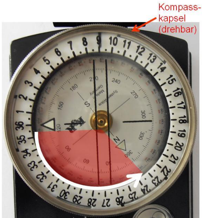
Abb. 4: Drehen der Kompasskapsel Quelle: eigene Darstellung
