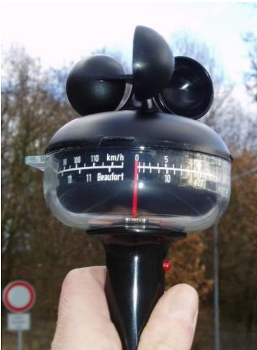
Abb. 6: Schalenanemometer
