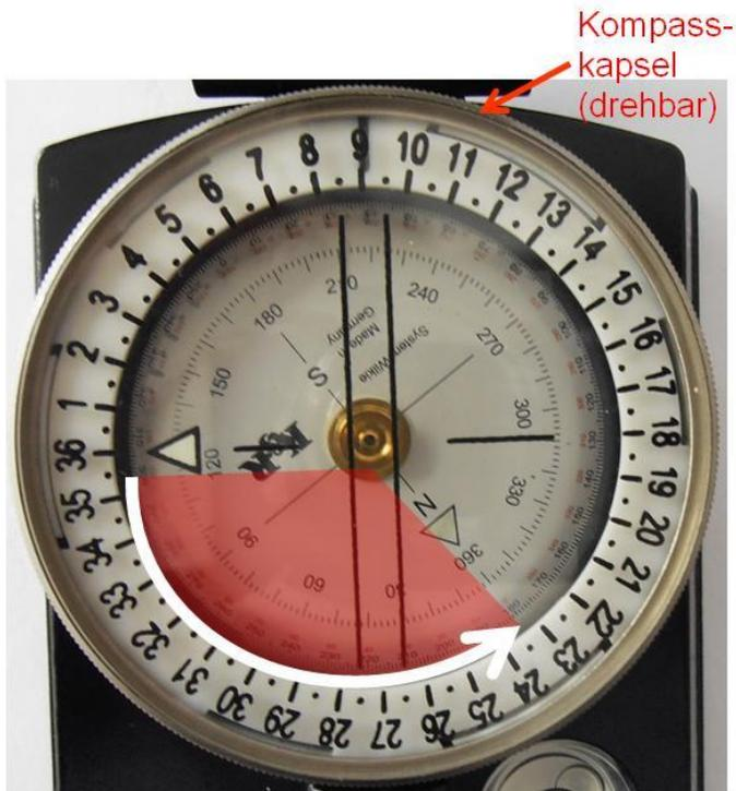
Abb. 4: Drehen der Kompasskapsel
