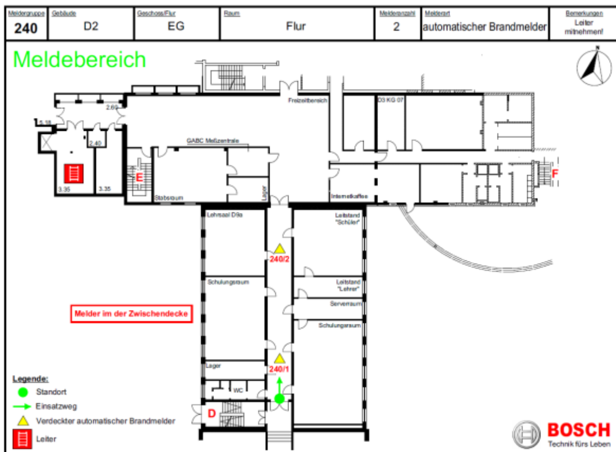
Abb. 20: Laufkartenrückseite mit Bemerkung und Zwischendeckenmeldern
