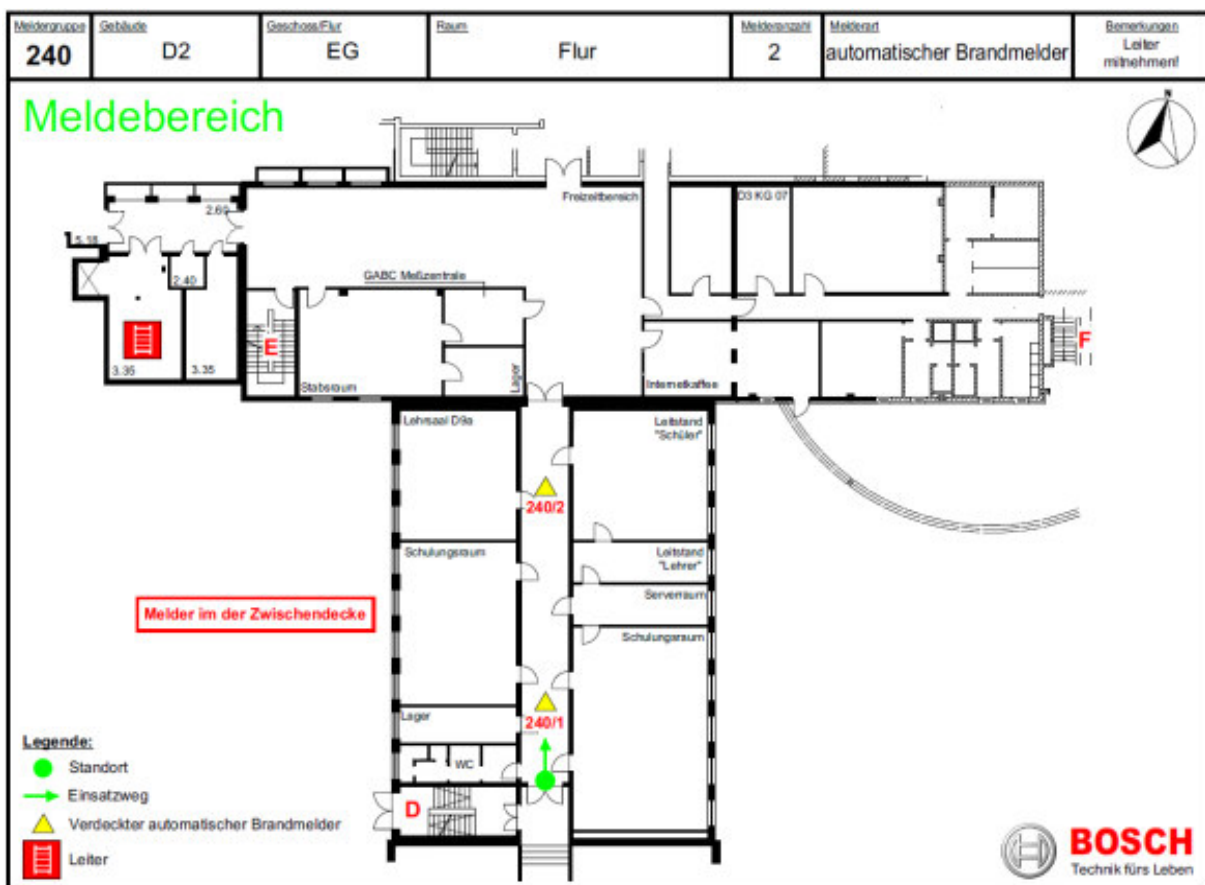
Abb. 20: Laufkartenrückseite mit Bemerkung und Zwischendeckenmeldern
