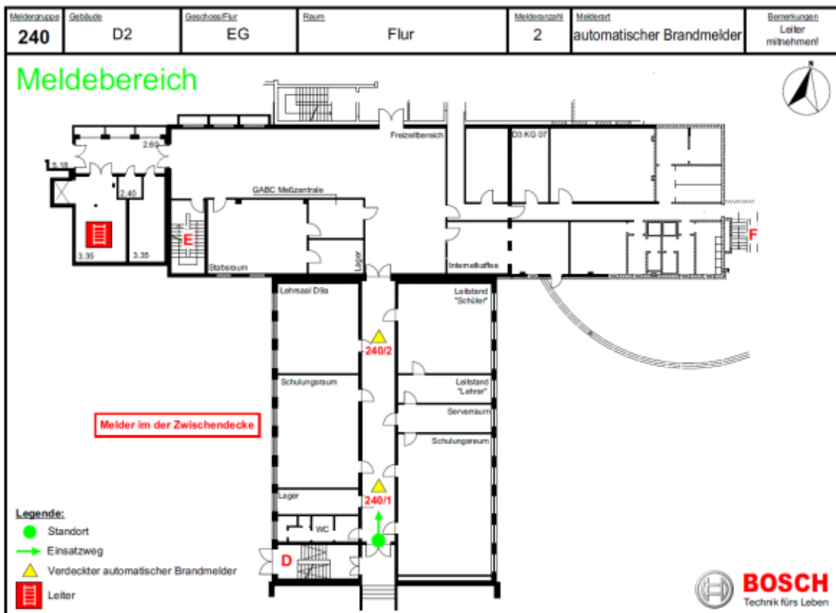
Abb. 20: Laufkartenrückseite mit Bemerkung und Zwischendeckenmeldern
